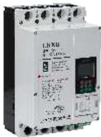
CKM3LG系列剩余电流动作断路器（低压分布式光伏保护开关），采用剩余电流重合闸塑壳断路器作为主体,增加光伏专用的保护功能、HPLC或HPLC双模通信功能、电能质量监控功能与精确计量等电力物联网功能。用于光伏发电系统接入低压电网的断路器，其功能全面、操作简单、维护方便，满足智能电网和电力物联网中光伏并网的应用需求。
